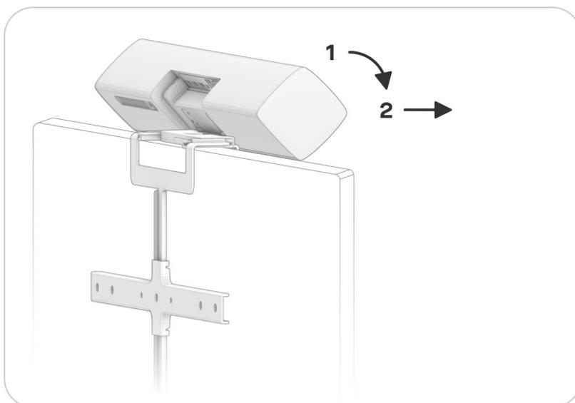
**Alerta:** Não deixe a Neat Bar em uma posição máx. inclinada com o indicador vermelho mostrando como que não está fixada pela mola de bloqueio.
