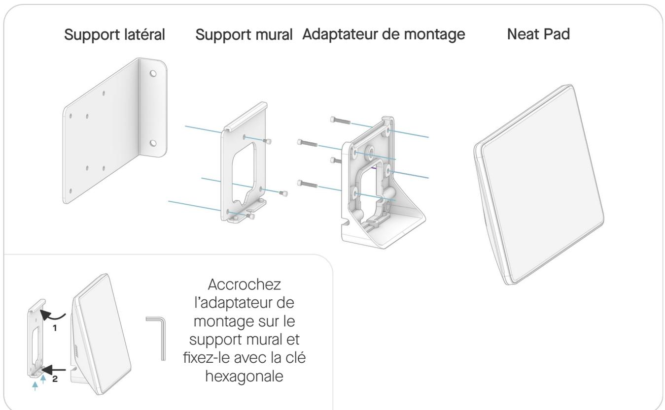
Les vis pour le montage au mur ne sont pas incluses. Le montage sur un mur doit uniquement être effectué par du personnel qualifié conformément aux réglementations du site et nationales en vigueur. Le mur et l'équipement de montage doivent supporter en toute sécurité la charge du produit.
